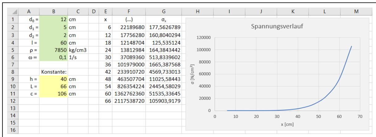
Bild 3. Arbeitsblatt zur Bestimmung des Spannungsverlaufs
