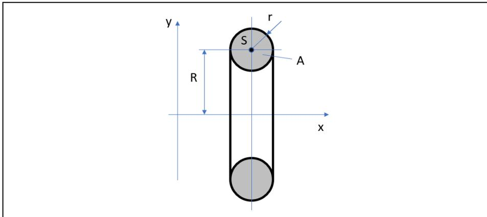
Bild 5. Die Rotation einer Kreisfläche erzeugt einen Torus
